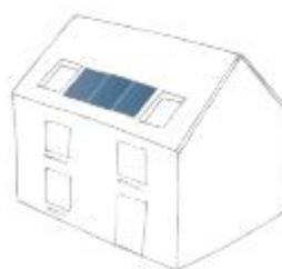
Associer les capteurs avec les fenêtres de toit pour former une composition d'ensemble qui soit visuellement un seul élément.
